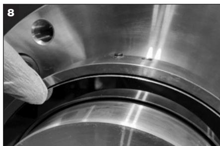
Pulire la faccia rotante con lo straccio fornito, accertandosi che non ci siano residui alle giunture. **Avvertenza:** Non premere sulla faccia di tenuta - si possono provocare dei disallineamenti delle facce.
