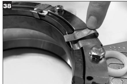
Installare le molle ausiliarie (6x - 8x) nelle due metà della flangia, tenendo la metà dell'anello di tenuta all'interno della flangia.
