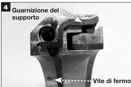
Accertarsi che le guarnizioni del supporto siano lubrificate e che vengano posizionate nelle loro scanalature. **Importante:** Le viti di fermo non devono sporgere oltre il diametro interno.
