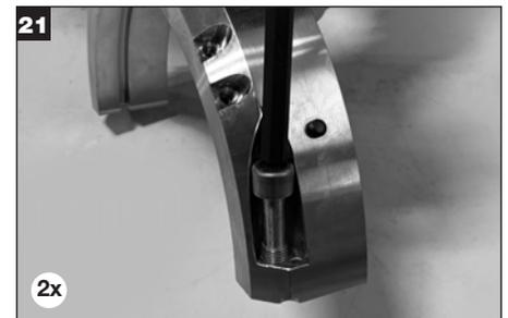
Lubrificare le filettature con un composto anti-grippaggio consigliato e installare le nuove viti a testa cava nel supporto della faccia rotante.
