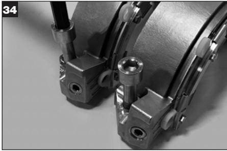
Installare le viti a testa cava della flangia nelle due metà della flangia (2x). **Nota:** Le viti a testa cava della flangia si trovano ad una estremità di ognuna delle due metà della flangia, lontano dalla scanalatura dei bulloni di montaggio.
