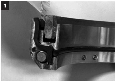
L'albero deve essere pulito e lubrificato prima dell'installazione del supporto della faccia rotante. Applicare il grasso fornito solo alle giunture della faccia. Non applicare grasso sulle estremità dell'O-ring.
