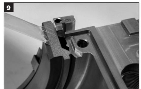
Applicare il grasso fornito solo alle giunture della faccia stazionaria. Non applicare grasso sulle estremità dell'O-ring. **Avvertenza:** Le particelle di sporco alle giunture delle facce di tenuta possono provocare delle perdite.
