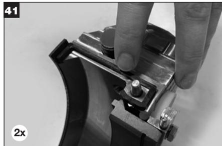
Applicare un sottile strato di grasso alle guarnizioni della flangia ed installarle nelle scanalature delle due metà della flangia. **Nota:** Le guarnizioni della flangia vanno installate all'estremità della flangia dove sporge la guarnizione della faccia della cassa stoppa.
