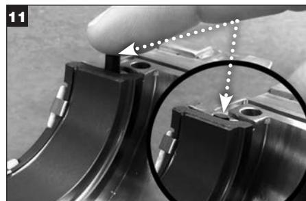
Accertarsi che l'O-ring della faccia stazionaria sia a livello con le giunture della faccia stessa ma non sporga sotto. Premere con attenzione sull'O-ring se sporge oltre le giunture della faccia. La preparazione è completa; **passare all'installazione della tenuta.**
